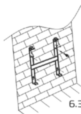
2. Просверлите отверстия в стене с помощью сверла диаметром 8 мм и вставьте дюбели в сделанные отверстия.
