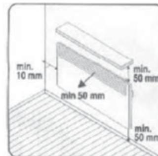
Рекомендуемая схема установки конвектора на стене.
