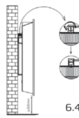
3. Закрепите кронштейн на стене с помощью крепежных винтов.
