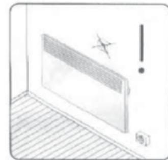
Конвектор не предназначен для размещения непосредственно под гнездом розетки.
